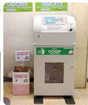
店舗に設置された ペットボトル小型減容回収機
