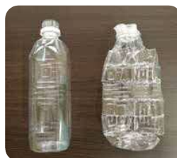
500mlペットボトル(写真左)を 圧縮減容した後(同右)
