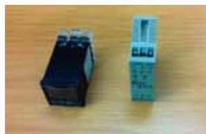
▶BEMSの装置。電力消費量を監視します
