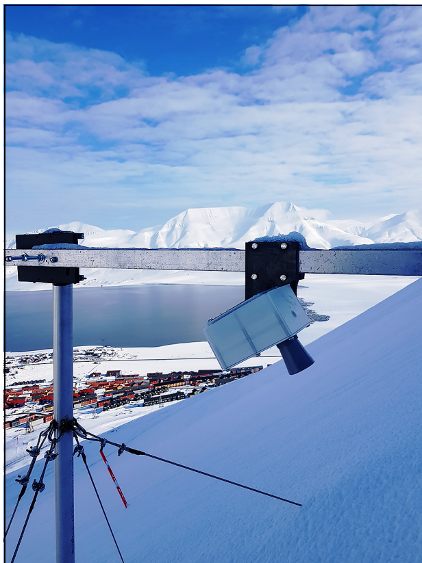
Figur 6.3 UNIS' snøsensoren for skredvarsling ovenfor Longyearbyen.
