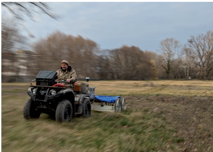
4 Bodenradarmessungen der GeoSphere Austria auf der Schiffswerftinsel in Budapest | Ground penetrating radar measurements by GeoSphere Austria on the shipyard island in Budapest (© ÖAW-ÖAI, C. Gugl)
