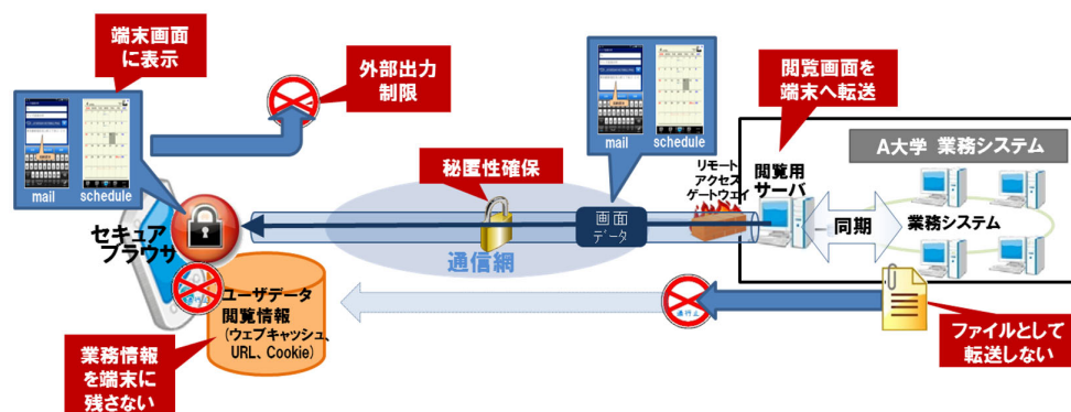
図6 セキュアブラウザ活用型ソリューションのシステム構成例
