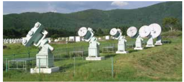
図06 1、2、3.75、9.4、17、35、80 GHzの太陽活動モニター用望遠鏡群の写真。手前の3つ並んだパラボラアンテナの真ん中が35 GHzで両側が80 GHz。以後、17、9.4、3.75、2、1 GHzの各アンテナが並ぶ。
