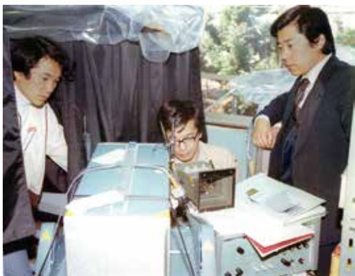
新しい小型の光偏向素子が開発され、それを使ったAOS（音響光学型電波分光計）を6m望遠鏡を使って性能試験をする海部さん（中央）、それを見守る素子を開発した松下電器の田中さん（右）と私（左）。
