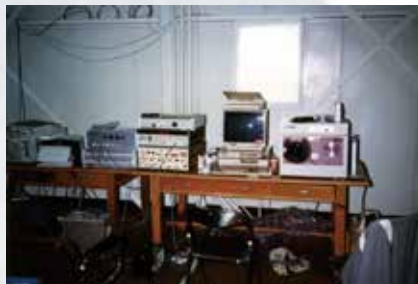
03 1986年 パルサー観測用の測定機器。
