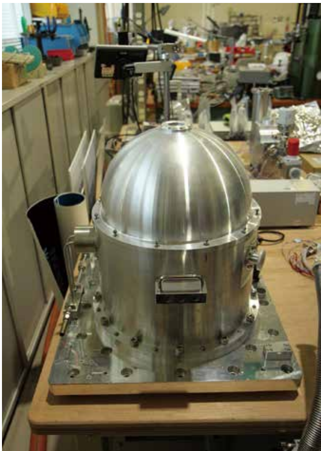
昔の映画に登場したような形のデュワー。これも真空冷却テストに使用する。
