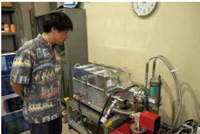
駆動機構の耐久試験などを行う中型デューワー。
