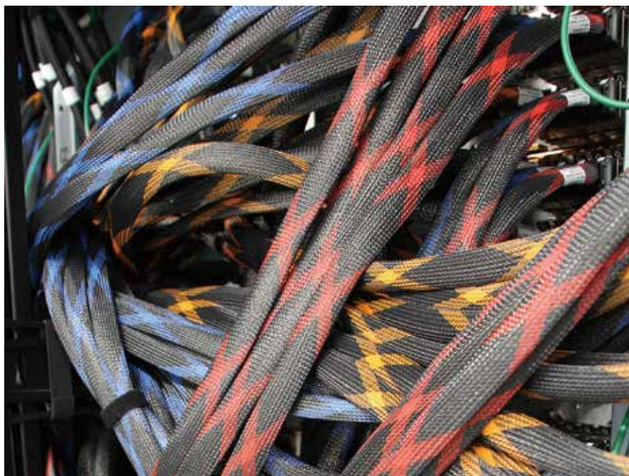
アテルイのCPU同士をつなぐインターコネクト(高速回線)のケーブル。このケーブルを通してCPU同士が通信を行い、並列計算が可能となる。スーパーコンピュータの「神経」にあたる。
