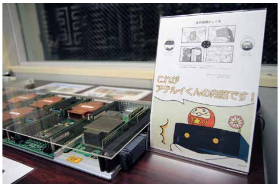
アテルイで実際に使われているブレード。1つのブレードには8個のCPUが搭載され、1つの筐体あたり48枚のブレードが差し込まれている、アテルイくんの「内臓」である。
