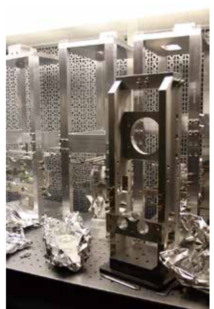
図08 LIGOのSOSタワーの1つ（前面）と他の光学部品を吊るすタワー（背景）。
