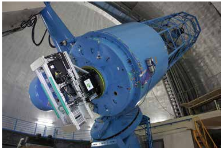
図03 岡山天体物理観測所の188cm望遠鏡と、カセグレン焦点に取付けられたトランジット惑星観測用の多色撮像カメラMuSCAT（図左側）。
