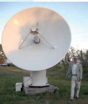
岐阜大学3m。世界最小の測地目的VLBI観測専用可搬型3mアンテナ（2003年・岐阜大学にて）。1980年代に筆者が明星電気の技術者と開発。マーカスプロジェクト（日本周辺の4つの地殻プレートの運動を監視するプロジェクト）において、南大東島にて運用された。
