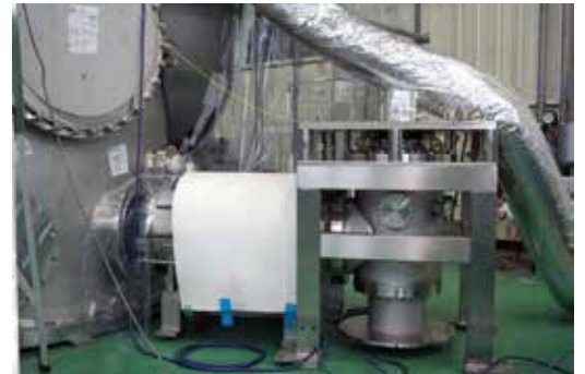
図01 試験中の2段式パルスチューブ冷凍機。1つのクライオスタットに4機が取り付けられます。
