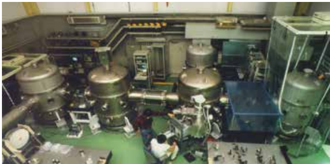
02 L字の交点にあたる中央真空タンク室（観測当時）。左から、モードクリーナー（の一部）、リサイクリングミラー、ビームスプリッター（中央）、西側ニアミラーの各タンクで、奥が南側ニアミラータンクです（16・17ページ）。現在の中央真空タンク室には、KAGRA開発のための真空タンクや試験用装置が多く増設されています。
