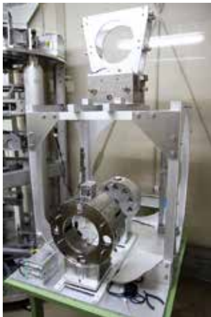
図02 開発中のペイロード。鏡を懸架する最終段の防振装置でプレ・アイソレーターに吊るされます。KAGRAの鏡は、5段にも及ぶさまざまな防振振り子装置を組み合わせることによって、極限まで振動を低減します。
