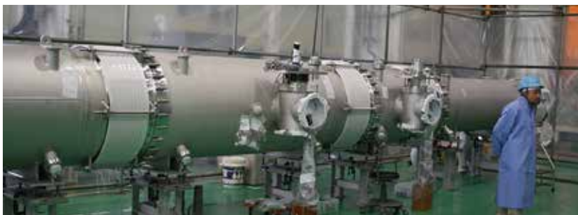
05 KAGRAのプレ・アイソレーター。この下に何段もの振り子を吊り下げて鏡の揺れを極力減らすための高性能の防振装置です（26ページ）。
