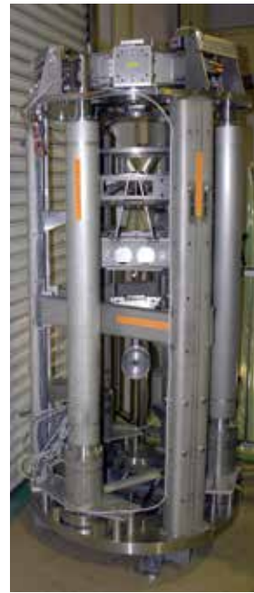
04 真空タンクの中に吊り下げられる鏡（中央下の丸い部分）とその揺れを防ぐ防振機構。タンク自体にもさまざまな防振対策が施されます。
