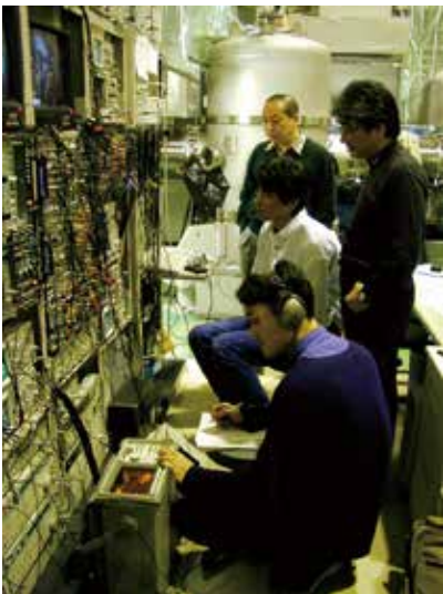
図06 雑音を耳で聞きながら雑音源を同定し、低減する「ノイズハンティング」のようすです。
