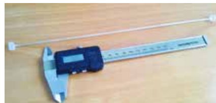
図03 ノギスの上に写っているのがサファイア鏡を吊るサファイアワイヤー（品質調査のためのテストピース）。
