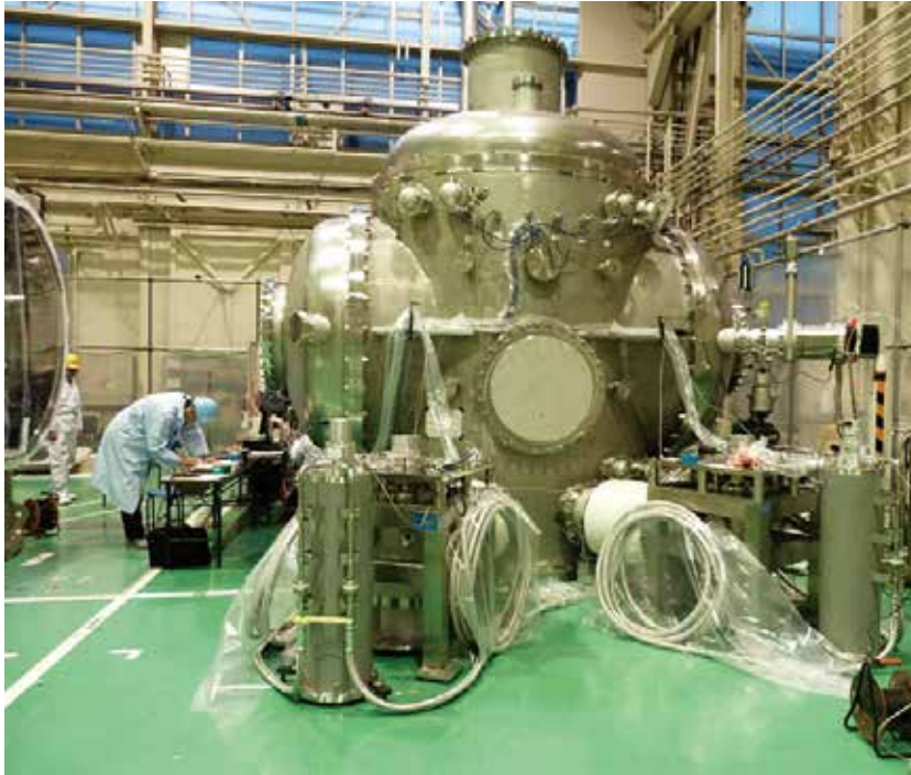
01 東芝の工場で真空・冷却試験中の真空タンク（クライオスタット）。
