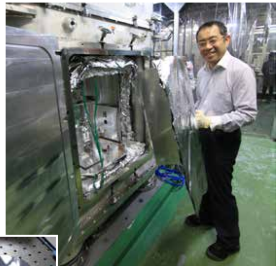
05 CLIOの高さ約2mの真空タンクは、熱雑音を下げるためにクライオスタット（cryostat / 低温保持装置）が組み込まれています。冷却によって感度を上げる方式も日本独自のものです。
