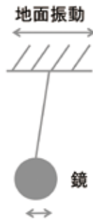
図04 鏡を吊りし、振り子の原理を利用して地面振動を防ぎます。
