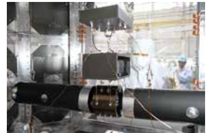
03 吊り下げられた中央の黒い円柱の中に -253^{\circ}\text{C} まで冷やされるサファイアの鏡（プロトタイプ）が置かれています（28ページ）。
