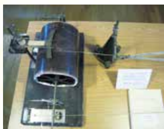
図2 記録部分。ドラムの記録紙は模造品。重錘式の時計仕掛けで駆動。
