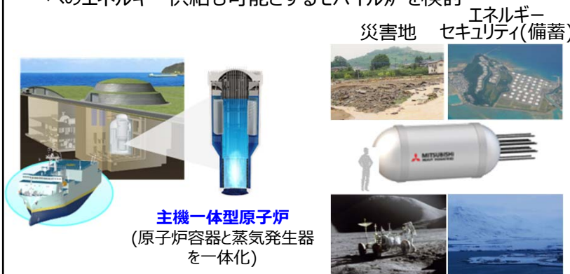
【軽水小型炉(発電炉/船用炉)】
