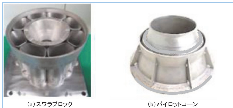
図 11 AMによる燃焼器部品のラピッドプロトタイピング
