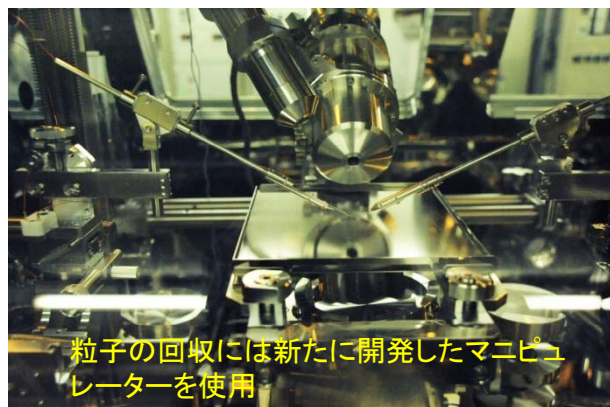
マニピュレーターでキャッチャーから回収された粒子(大きさ:おおよそ10ミクロン)
