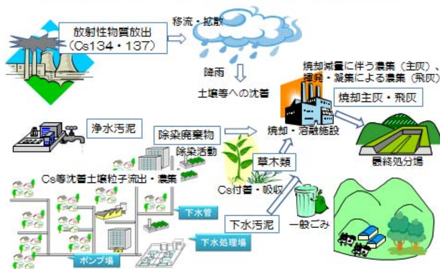
図 1.1 主要な放射能汚染廃棄物である福島県内の災害廃棄物、下水汚泥、上水汚泥（上水発生土）、一般ごみの焼却灰等が放射性物質に汚染された事象の機序（メカニズム）の概要
