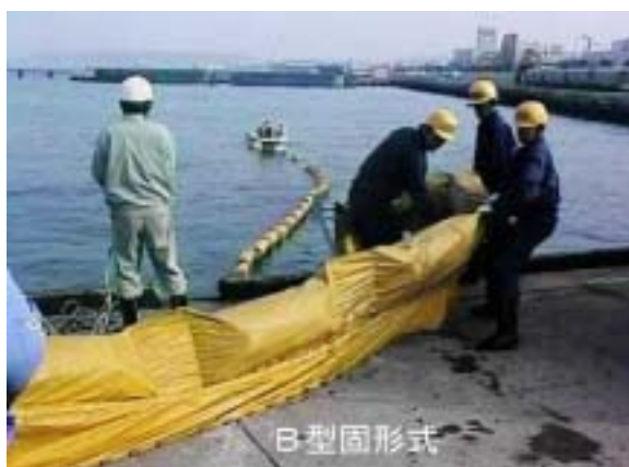
B型固形式オイルフェンス (海上災害防止センター 所蔵)
