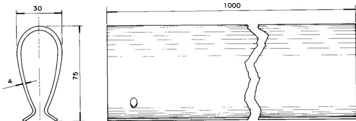
**Figura 1** - Calha protetora de Rede Compacta
