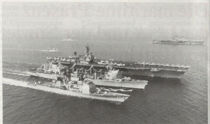
Kernstück der 6. US-Flotte sind die Trägerkampfgruppen, von denen eine bis zwei, in Krisenzeiten auch mehr, zum Verband gehören. Die Aufnahme zeigt den Flugzeugträger USS «John F. Kennedy», der zusammen mit dem hochmodernen Raketenkreuzer USS «Ticonderoga» (vorne) vom Versorgungsschiff USS «Detroit» im Mittelmeer Treibstoff, Munition und Lebensmittel übernimmt. Im Hintergrund der Flugzeugträger USS «Independence».
