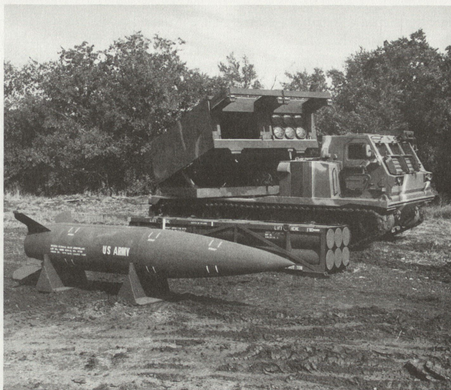
Bild 5. MLRS (LTV) mit Raketenbehälter und Artillerierakete (links).
