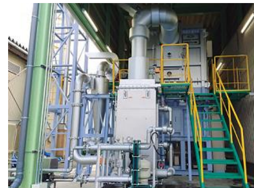
共同開発に成功したもみ殻処理炉
