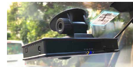
全営業車両にテレマティクスを導入して、リアルタイムで運転状態を「見える化」。エコドライブとともに、安全運転を促進しています
