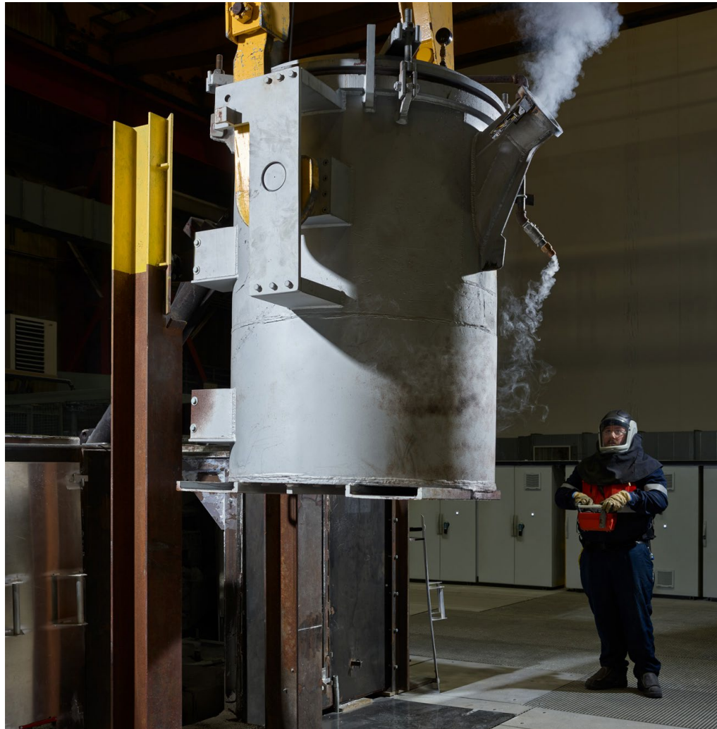
ELYSIS 创新的无直接碳排放冶炼工艺或将减轻制铝过程对气候的影响, 而铝正是全球使用最广泛的金属之一。
