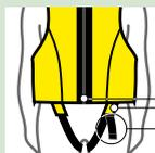
ウエストバックルとクロッチ（股）ベルトのバックル色を変えることで付け間違いを防ぎます。
