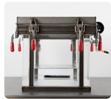
Bij de waterbestendigheidstest voor de IPX7/8-norm wordt een iPhone ondergedompeld in een drukvat om waterdruk na te bootsen.
