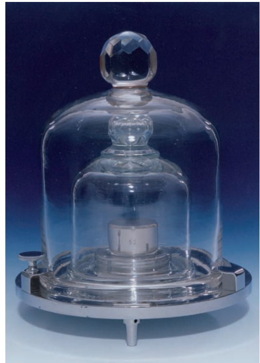
Bild 2: Kilogrammprototyp Nr. 52 der Bundesrepublik Deutschland (aufbewahrt unter zwei Glaslocken)
