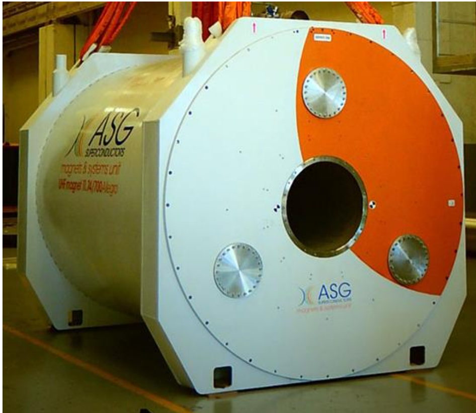
Head-only, 11.7 T MRI ( \text{Nb}_3\text{Sn} )
