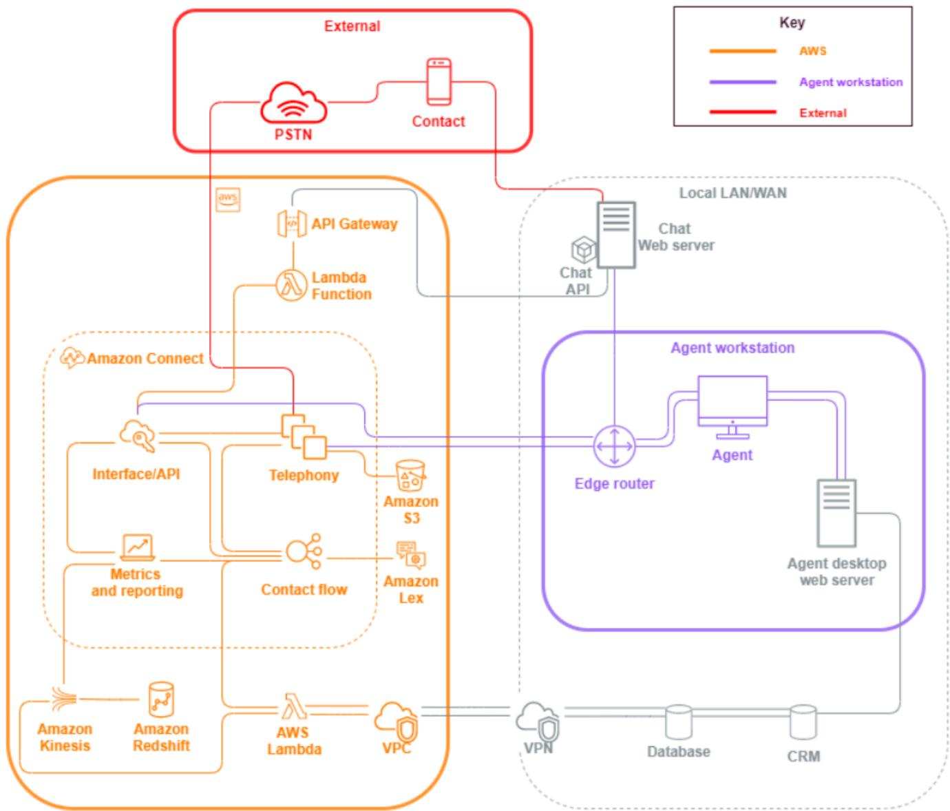
1. 座席工作站。代理工作站层不由任何物理设备 AWS 和第三方技术、服务和终端节点管理，这些设备和终端节点可为代理提供语音、数据和访问 Amazon Connect 接口层。
