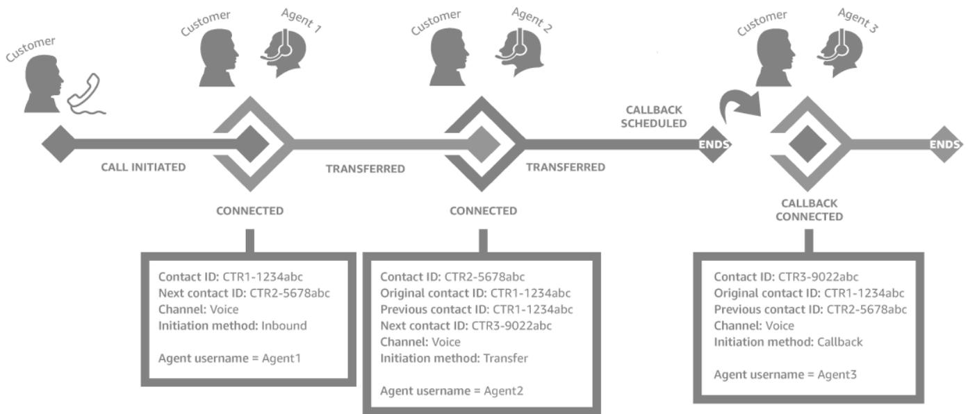
每次联系人连接到座席时，都会创建一个新的联系记录。联系人的联系记录通过以下 `contactId` 字段链接在一起：“初始”、“下一步”、“上一个”和 [RelatedContactId](#)。
