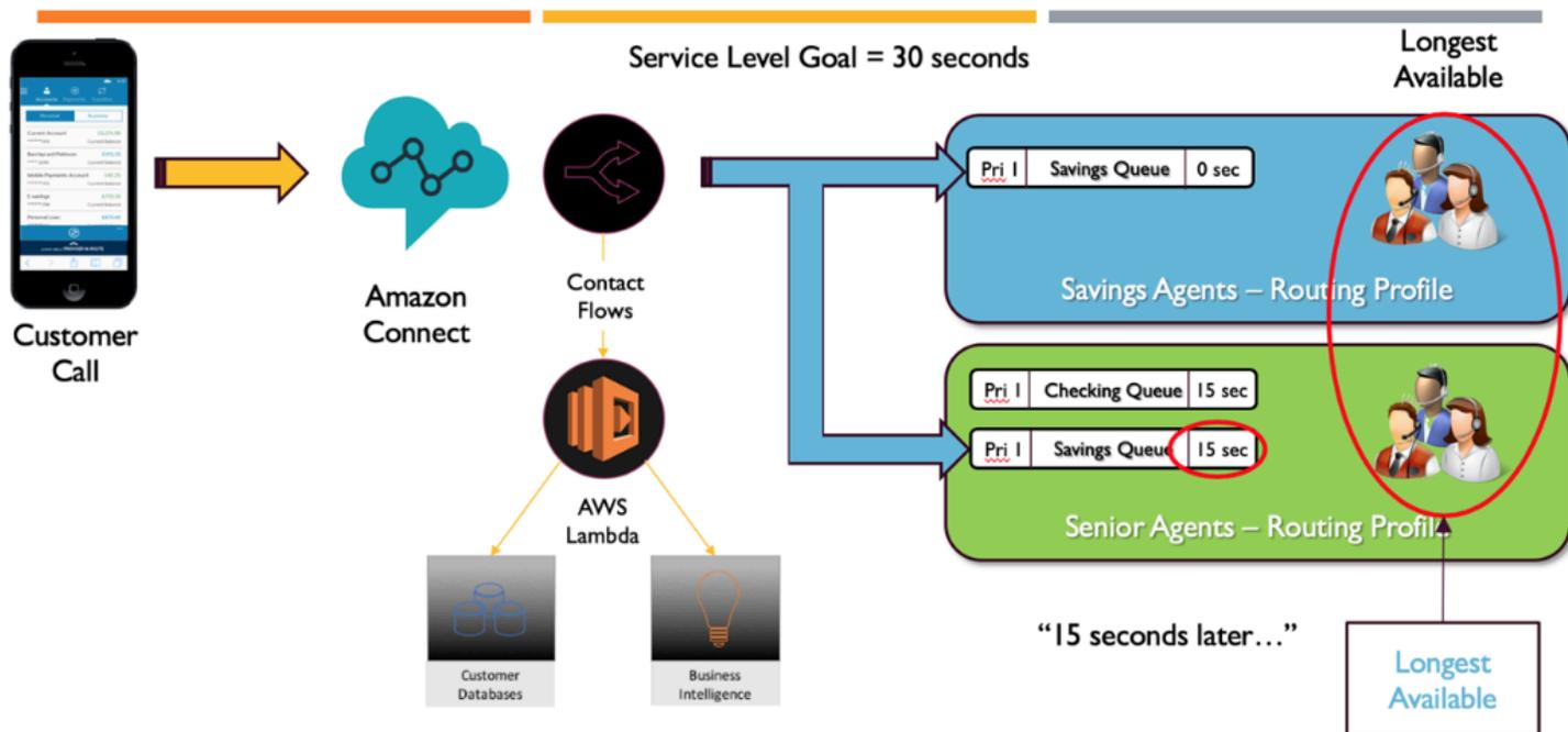
此图显示SLA的是 30 秒。储蓄队列中有呼叫拨打进来。由于队列的配置文件中配置了 0 延迟，因此储蓄队列会立即在“储蓄”路由配置文件中查找座席。由于高级座席配置了 15 秒延迟，因此他们在 15 秒内将没有资格接听储蓄联系人。15 秒后，高级座席可接听联系人，Amazon Connect 会在两个路由配置文件中查找空闲时间最长的座席。
