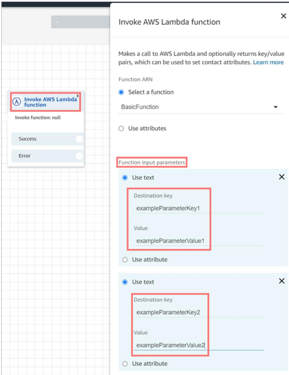
Invoke Lambda 模块可以接收JSON格式的输入参数，既可以容纳原始数据类型，又可以嵌套数据。JSON以下是可以在 Invoke Lambda 区块中使用的JSON输入示例。
