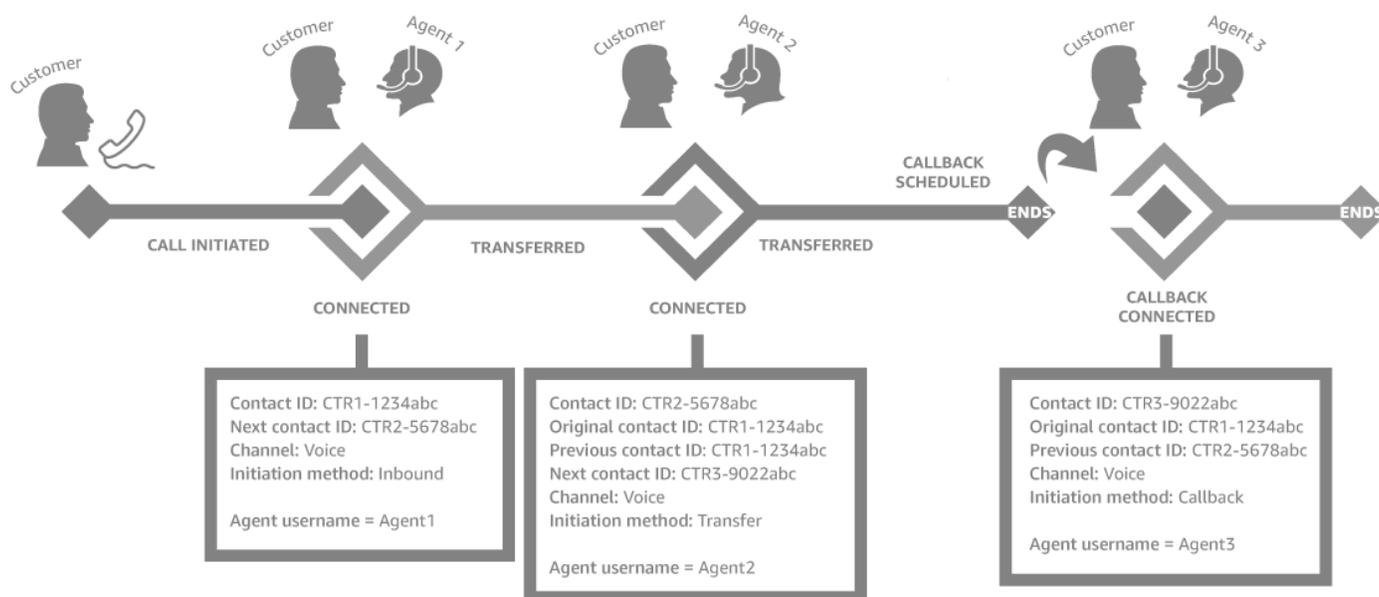
每次联系人连接到座席时，都会创建一个新的联系记录。联系人的联系人记录通过以下contactId字段链接在一起：“初始”、“下一步”和“上一个”。
