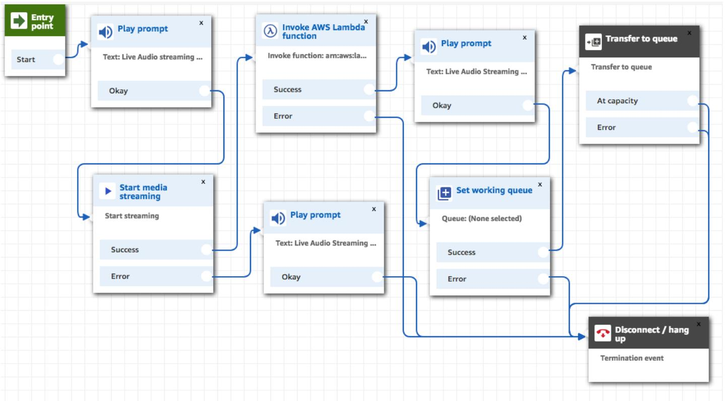
成功将音频流式传输到 Kinesis Video Streams 后，将从 Invoke AWS Lambda 函数块中填充联系人属性。您可以使用属性来识别流中客户音频开始的位置。有关说明，请参阅 [Kinesis Video Streams 中直播媒体的联系人属性](#)。
