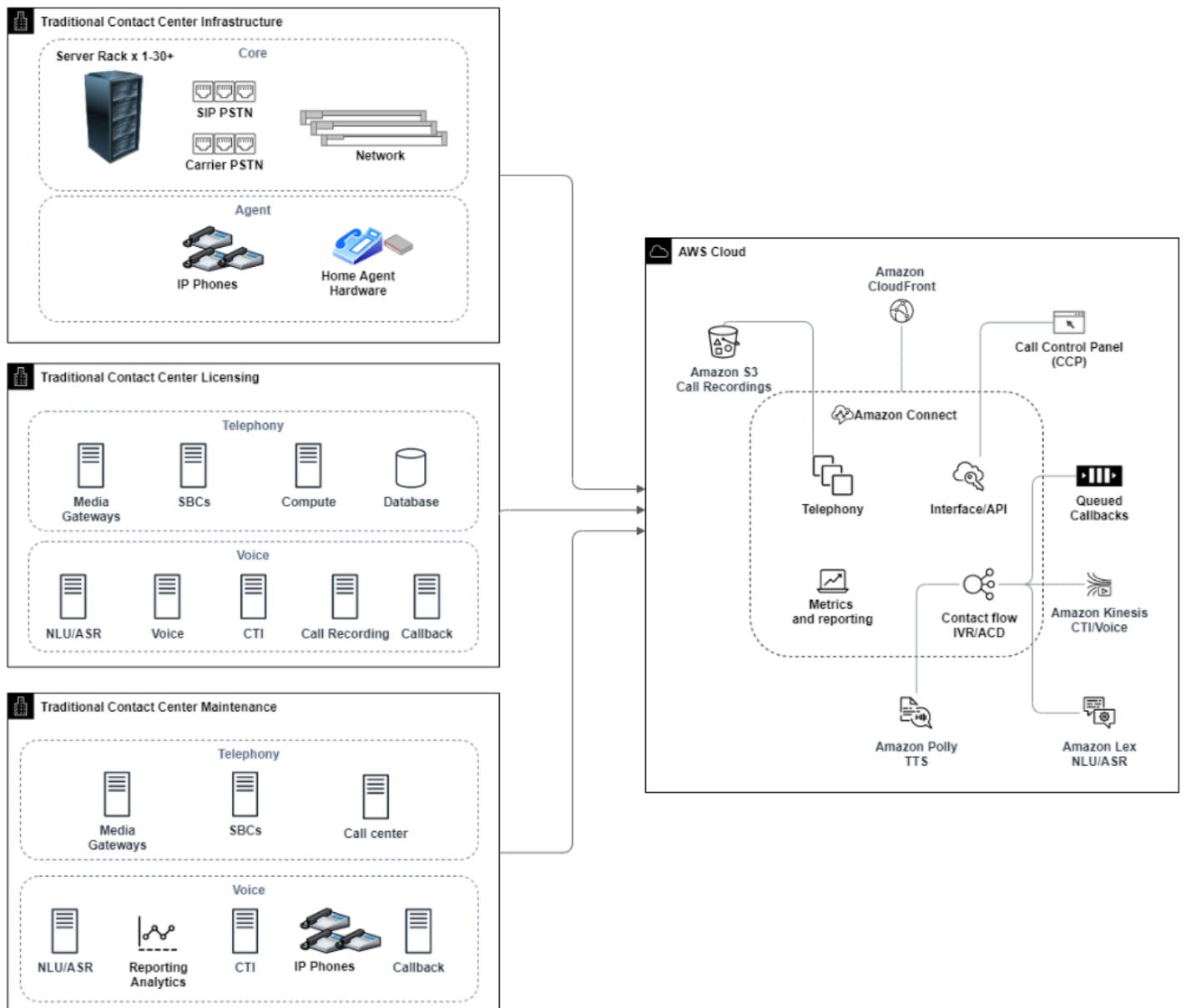
典型的 Amazon Connect 部署可以解决或减少与版本控制、兼容性、许可、联系中心电话基础设施和维护相关的许多挑战。它使您能够在几分钟内在新位置灵活地创建实例，并单独或并行迁移组件，以最大程度地满足您的个人业务目标需求。您可以将流程用于IVR/ACD，通过支持的网络浏览器将语音和数据传输到代理的软件电话，移植您的现有电话号码，将软件电话音频重定向到现有的桌面电话，在流程中本地调用 Amazon Lex 机器人来实现ASR和NLP，以及使用相同的流程进行聊天和语音。您可以使用 Amazon Contact Lens 自动生成语音转录、执行关键词识别和情绪分析以及对联系人进行分类。对于代理CTI数据和实时语音流，您可以使用 Amazon Connect 代理事件流和 Kinesis Video Streams。您还可以创建多阶段开发、质量保证和测试环境，无需支付额外费用，只需按实际用量付费。
