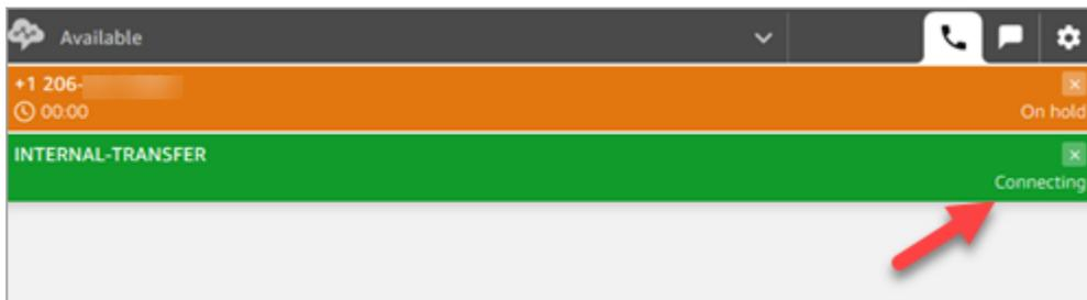
2. Amazon Connect 调用与 PasswordReset 快速连接相关的队列传输流程。在此流程中，[转接队列](#)区块会将联系人转移到 PasswordReset 队列，因为该联系人是在区块中指定的。该联系人现在在 PasswordReset 队列中。
