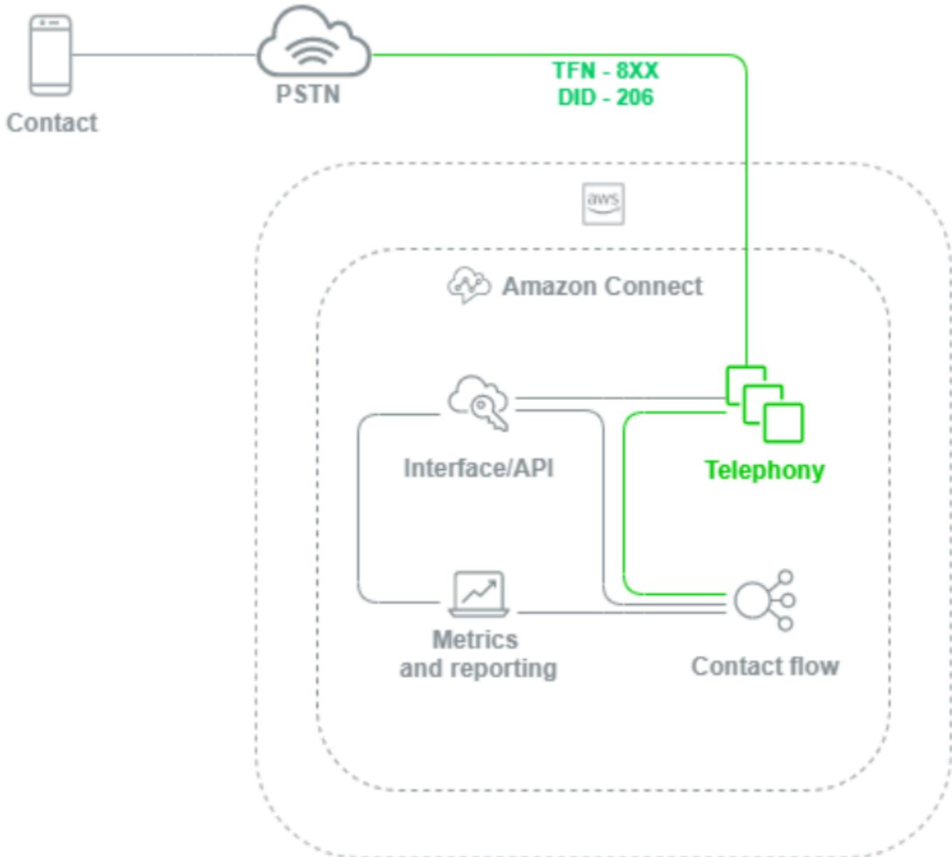
当向 Amazon Connect 实例拨打语音呼叫时，电话层负责控制您的客户通过其运营商呼入的终端节点，通过该终端节点呼入 PSTN 并进入 Amazon Connect。该层表示 Amazon Connect 与客户之间建立的音频路径。通过 Amazon Connect 接口层，您可以配置诸如出站来电者 ID、为电话号码分配流量/IVRs、启用直播媒体流、启用通话录音以及无需任何传统电话知识或经验即可声明电话号码等内容。
