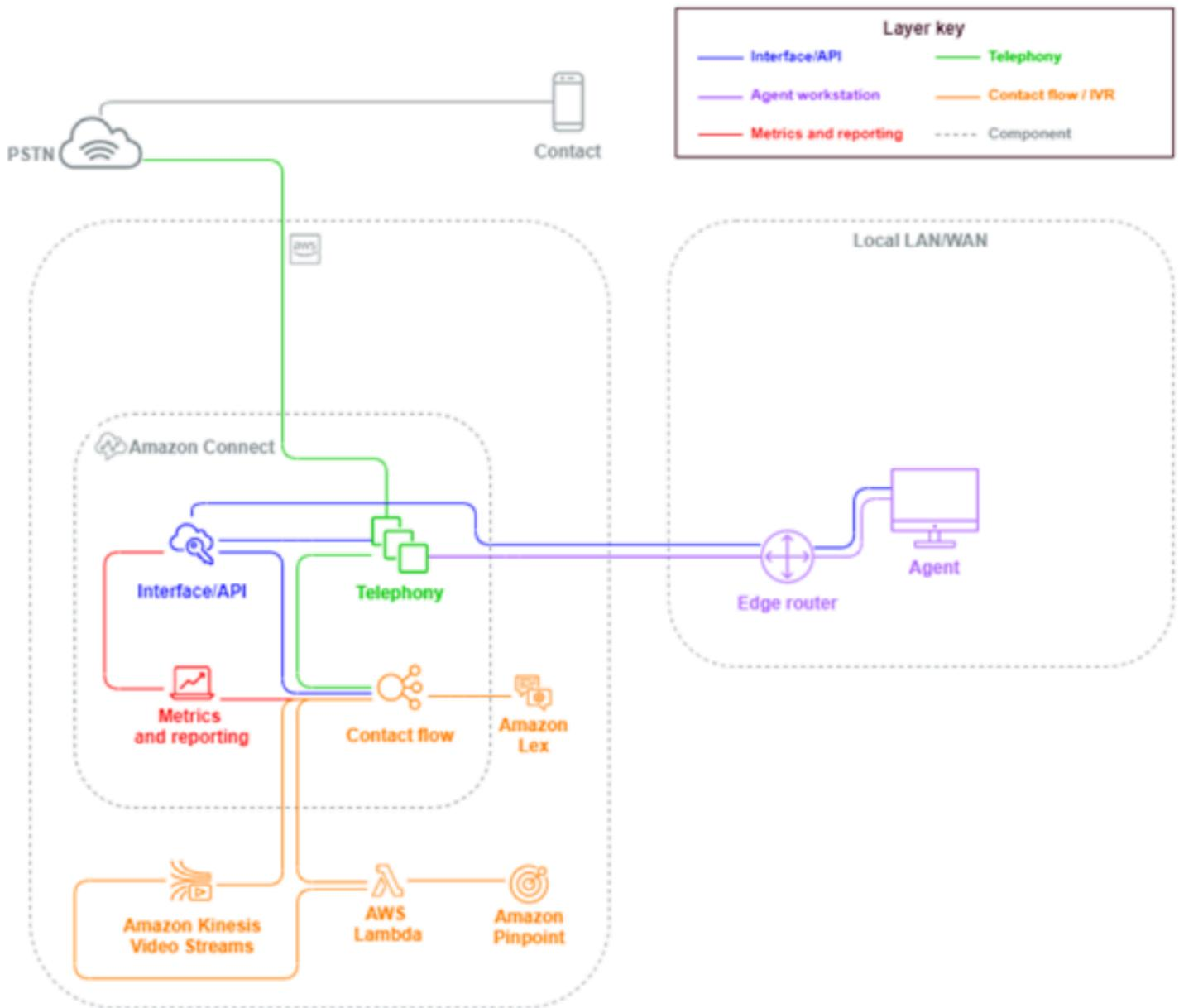
当向 Amazon Connect 实例中申请或转网到的号码拨打电话时，将调用与被叫号码关联的流。您可以使用无需编码知识即可配置的流数据块来定义流。流可确定应如何处理和路由联系人，可以选择提示联系人提供其他信息以协助路由决策，将这些属性存储到联系详细信息中，并在必要时将该联系人路由到座席，并附上在整个过程中收集的所有叫详细信息和转录。通过该流程，您可以调用 AWS Lambda 函数来查询客户信息，调用 Amazon Pinpoint 等其他 AWS 服务发送短 SMS 信，以及使用原生 AWS 服务集成，包括适用于 NLU/NLP 的 Amazon Lex 和 Kinesis Video Streams 来实时直播语音通话。
