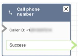
数据块没有错误分支。如果呼叫未成功发起，则流程将结束，代理将置于 AfterContactWork(ACW) 中。
