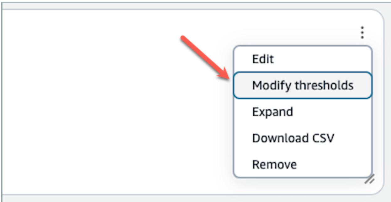
每个指标最多可以添加三个阈值 ( 红色、黄色、绿色 )。您可以定义导致指标变色的阈值。阈值按其应用顺序进行评估，这意味着如果您有重叠的阈值，则第一个触发的阈值将为相应的指标着色。这意味着，如果要为大于 90% 的绿色、90%-70% 的黄色和小于 70% 的黄色创建red/yellow/green配置，则应按以下顺序创建三个条件：
