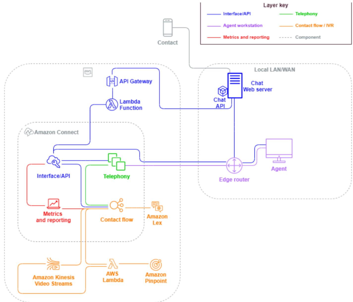
当入站联系人来自浏览器或移动应用程序的聊天会话请求时，该请求将被路由到网络服务或 Amazon API Gateway 终端节点，该终端节点会调用 Amazon Connect 聊天API以调用您在请求中配置的流程。您可以对聊天和语音使用相同的流，其中体验是根据流中定义的逻辑动态管理和路由的。
