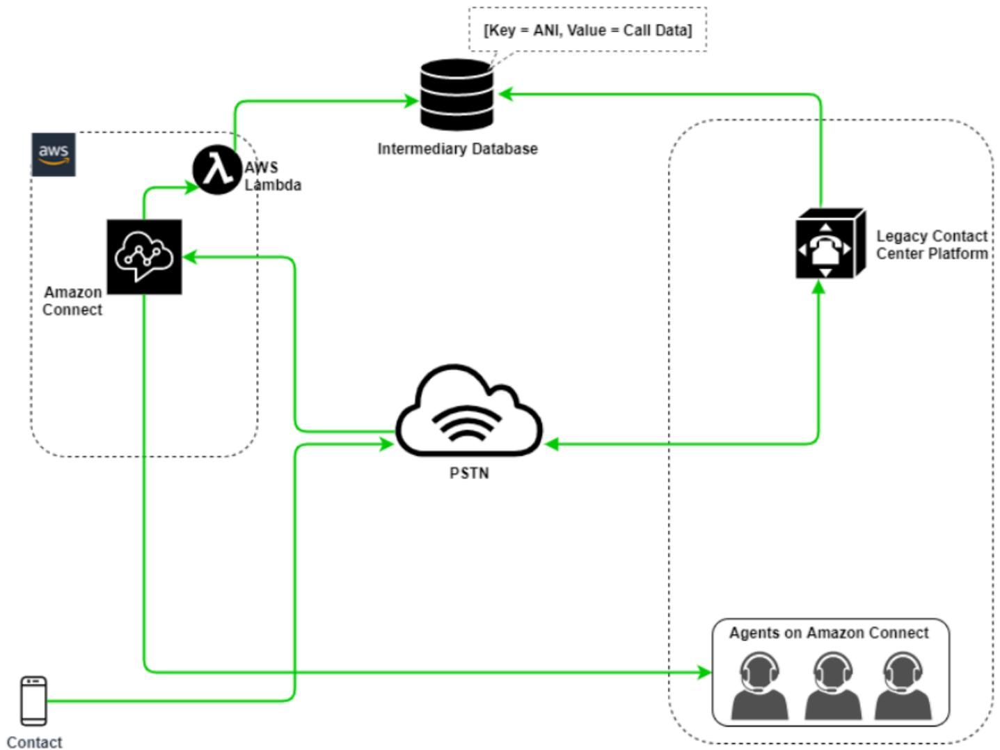
在此图中，联系人拨打的是您在传统联系中心平台上申请的电话号码。如果需要将其转接给 Amazon Connect 上的座席，传统联系中心平台将查询可用的唯一电话号码，将其标记为正在使用中，并将相关联系详细信息写入到中间数据库。然后，该联系人将使用由传统联系中心查询返回的电话号码转接到 Amazon Connect。然后，Amazon Connect 将使用 AWS Lambda 中介数据库查询联系人详情，进行相应的路由，然后重置中间数据库中的联系人数据，从而允许再次使用该电话号码。
