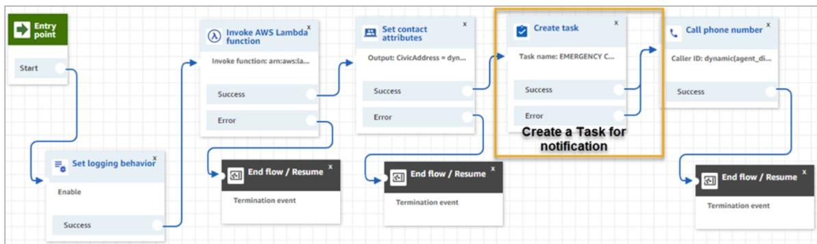
下图显示了[创建任务](#)数据库的属性页面。它被配置为通知公司安保人员，联系中心的座席已拨打 E911 电话。
