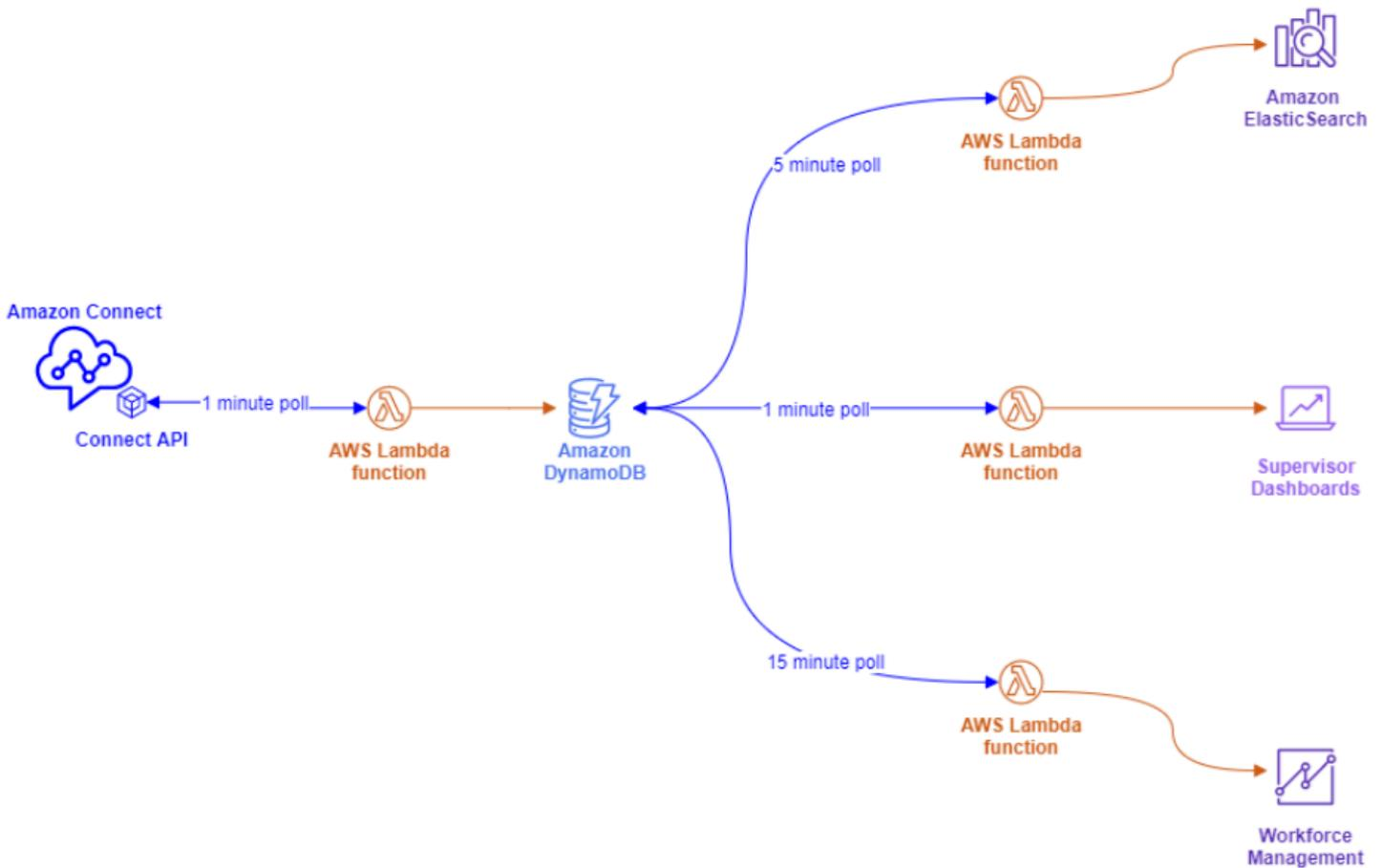
此架构允许您根据需要更改轮询间隔并添加端点，而不必担心超出服务限额，从而使您能够扩展到数据库解决方案支持的任意数量的并发连接。您可以使用这一相同的概念来查询来自 Amazon Connect 的任何实时数据源。对于需要执行某项 API 操作（例如出站 API 呼叫）的情况，您可以将同样的概念与 Amazon Simple Queue Service AWS Lambda 结合使用来对 API 请求进行排队 SQS。
