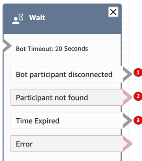
1. 自动程序参与者已断开连接：自定义参与者（例如第三方自动程序）已成功断开与联系人的连接。
