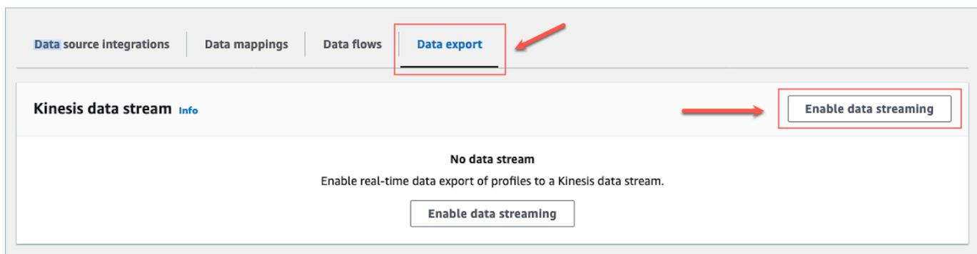
3. 选择启用数据流式处理并从下拉菜单中选择现有的 Kinesis 数据流，或者选择创建新的 Kinesis 数据流以打开 Kinesis 控制台并创建流。有关更多信息，请参阅[创建和管理流](#)。
