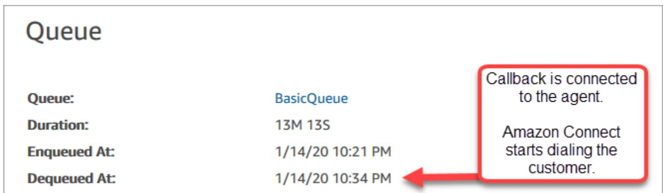
特定回拨分支在联系记录上的排队时间，对应于进行特定回拨尝试之前联系人处于队列中的时间。这不是在所有联系记录上的总排队时间。
