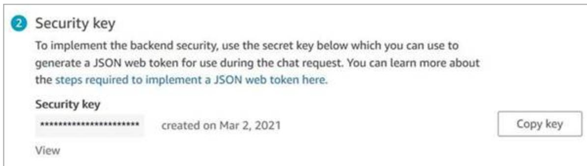
当您的客户与您网站上的“开始聊天”图标进行互动时，通信小部件会请求您的网络服务器提供JWT。提供此功能JWT后，该小工具会将其包含在最终客户向 Amazon Connect 发出的聊天请求中。然后，Amazon Connect 会使用密钥解密令牌。如果成功，则确认是由您的网络服务器发出JWT的，并且 Amazon Connect 会将聊天请求路由到您的联络中心客服。
