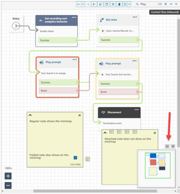
以下GIF示例说明了如何使用迷你地图在大型流量中导航。单击或轻触迷你地图，将视图移动到流设计器上所需的位置。
