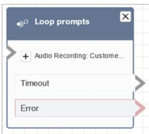
下图显示了该数据块配置为播放 Amazon S3 中的提示音时的样子。选择 S3 路径旁边的“+”已查看完整路径。已配置的数据块有两个分支：超时和错误。
