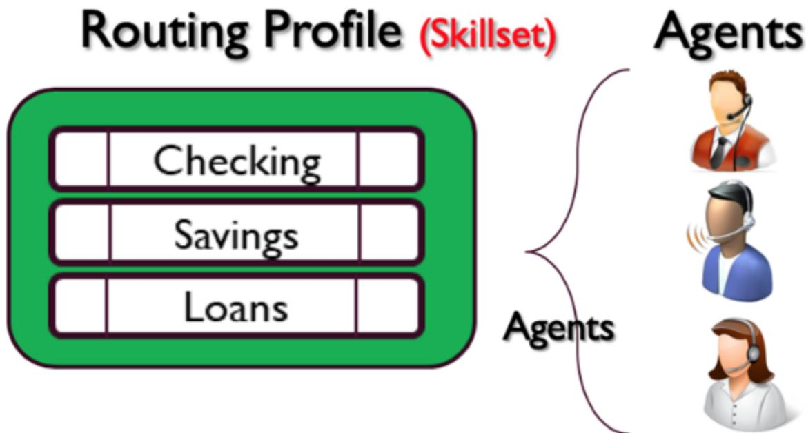
每个电话号码或聊天端点将与一个流相关联。该流会执行其逻辑，其中可能包括提示客户提供信息，以确定联系人的需求，并最终将联系人路由到适当的队列中。下图描述了路由配置文件、队列和流如何协同工作为联系人提供服务：
