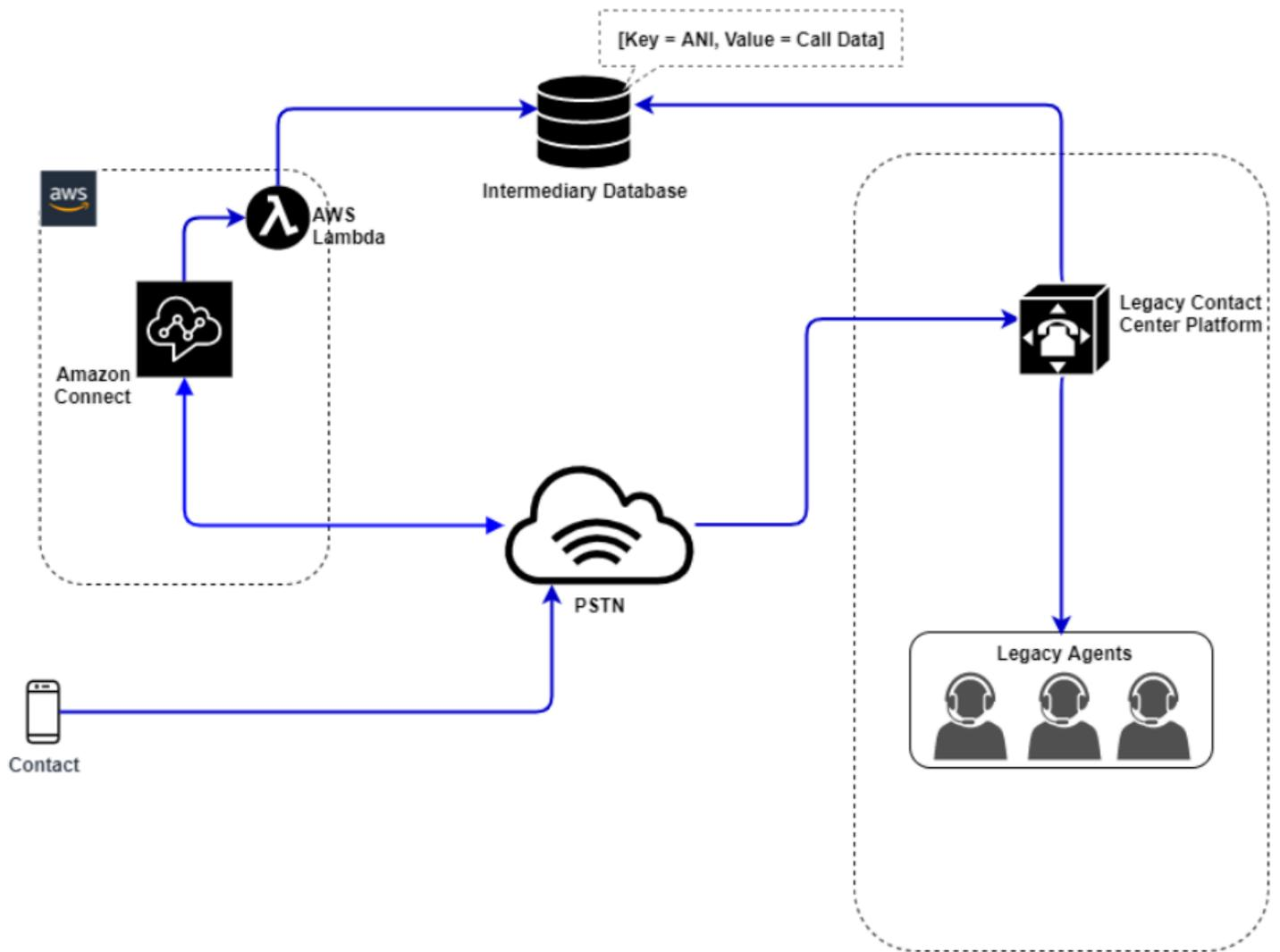
在此图中，联系人拨打您的 Amazon Connect 实例中申请的电话号码以获取服务。如果需要将其转移到旧版联络中心平台上的客服人员，则会调用一个 AWS Lambda 函数来查询可用的唯一电话号码，将其标记为正在使用中，并将相关的联系方式写入中间数据库。然后，使用从 Lambda 函数返回的电话号码将联系人转接到传统联系中心平台。然后，传统联系中心将在中间数据库中执行联系详细信息的查询，相应地进行路由，并重置中间数据库中的联系人数据，从而允许再次使用相应电话号码。
