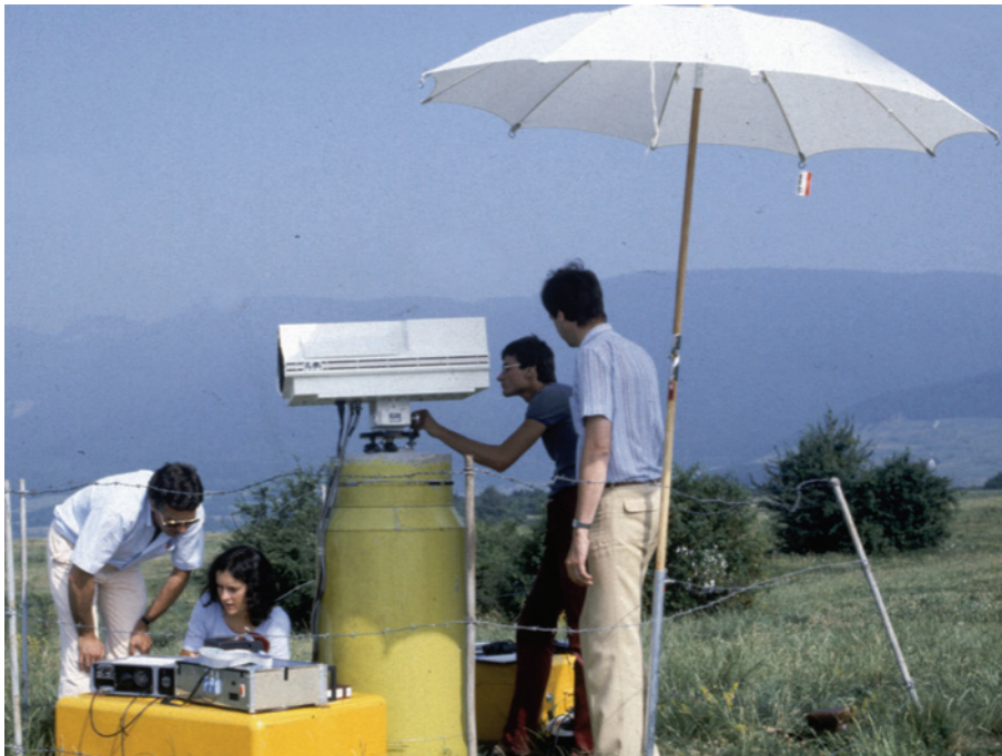
Photo 8—1984 : 1 mm pour 10 km \rightarrow 10^{-7} Le réseau géodésique LEP servait d'étalon du GPS
