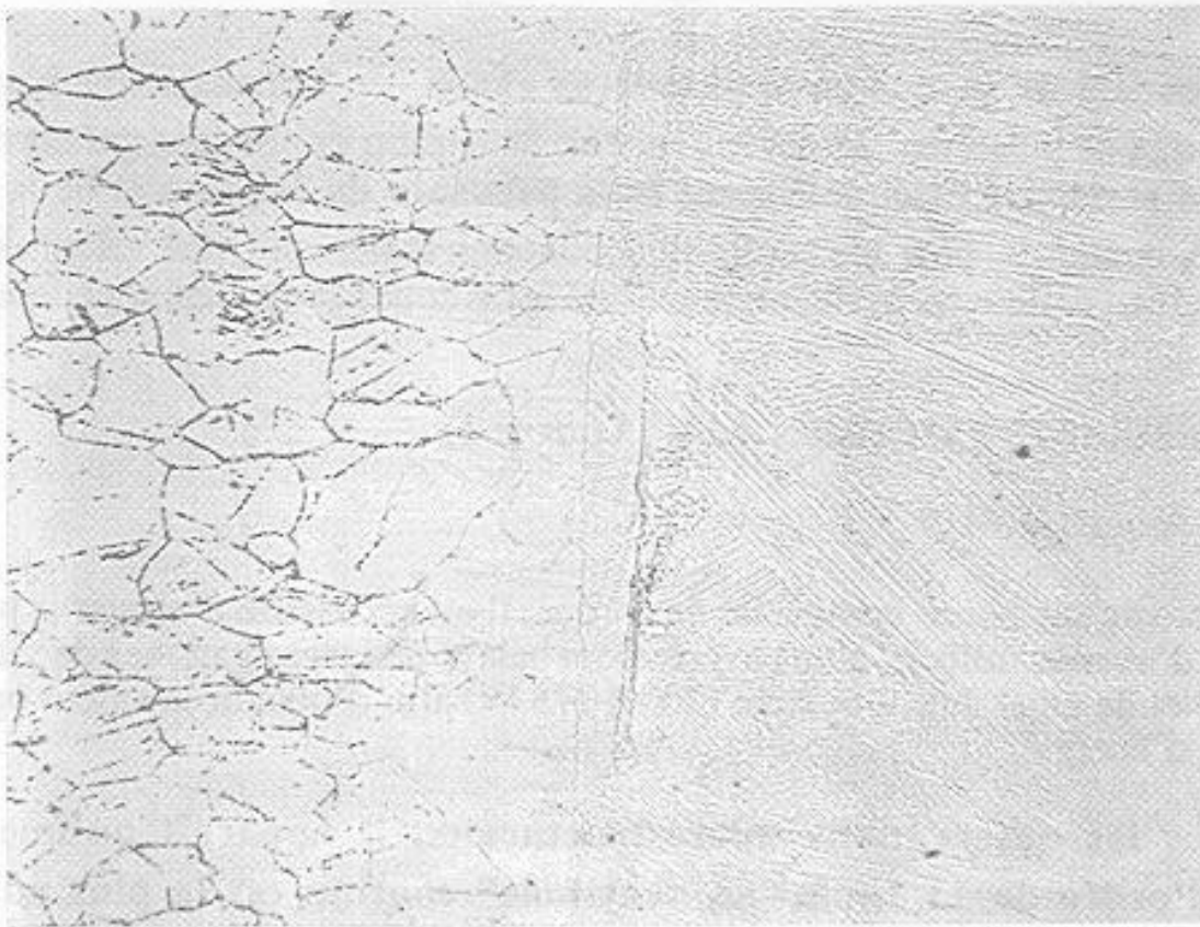
Photos 1 - échantillon S4 13RM19 ; vitesse d'avance 2.5 m/min, puissance moyenne 330 W.
