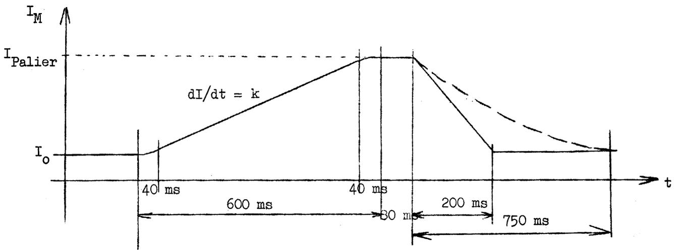
Les temps indiqués sur la figure indiquent les valeurs choisies pour la spécification de l'alimentation. La descente en pointillé indique le temps nécessaire pour une dé-excitation sans tension inverse.
