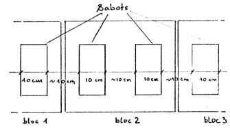
Cette solution permet de fixer la position des 13 conducteurs avec suffisamment de précision, de telle sorte qu'il ne soit plus nécessaire de vérifier la position individuelle des conducteurs. En effet les 13 conducteurs actifs peuvent être collés à l'aide du sabot à une précision de ± 0,1 mm par rapport au sabot rainuré, c'est-à-dire par rapport à l'un des conducteurs.
