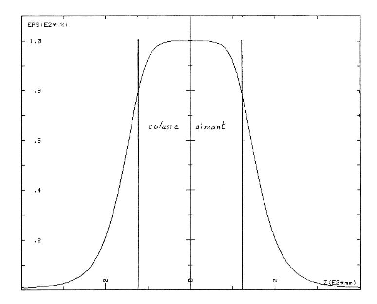
EPA-MBW0159-No1 : Loupe de la mesure de B=F(Z) 24/09/1985 B(0,0,0) = 2.423E-02 T à I = 8 A
