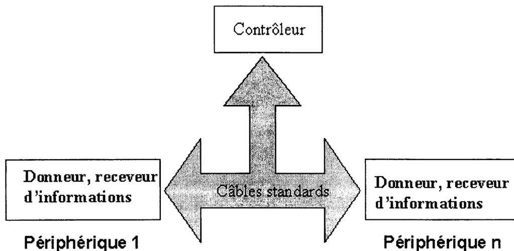
Le concept GPIB exprimé dans le standard IEEE 488 a facilité l'interconnexion physique de divers instruments mais il n'a pas facilité la discussion avec chaque instrument pour le programmeur. Les formats des instruments étaient les spécifications manquantes à la base du standard IEEE 488.2, adopté en 1987.
