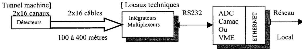
\*Beam Loss Monitors: 190 positions sont réparties entre le Booster, le PS et les tunnels de transfert.
