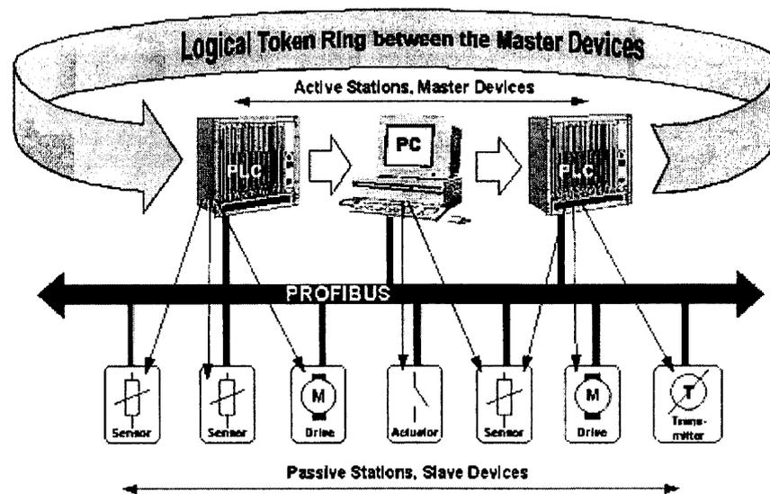
La norme EN 50170 de PROFIBUS spécifie les caractéristiques fonctionnelles, électriques et mécaniques d'un bus de terrain à transmission série.
