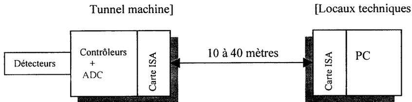
**\*En résumé:** Une électronique de tête est placée près du détecteur dans la machine. Les signaux analogiques traités par une électronique spécifique sont transmis à travers de nombreux câbles, sur de grandes longueurs, et donc soumis à de nombreuses sources de perturbations avant d'être digitalisés par un système de contrôle et distribués sur un réseau local Ethernet.
