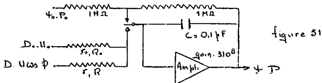
Le schéma de principe est classique, un relai permet de déclencher l'intégration à partir de conditions initiales données  $\phi_0 \cdot P_0$
