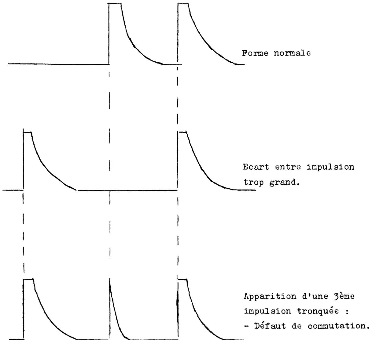
L'adjonction d'un délai supplémentaire de 200  $\mu$ s (sur MA) supprime cette instabilité, et permet de descendre sur le palier toujours avec les mêmes mutateurs (ex. BC1, puis BB2).
