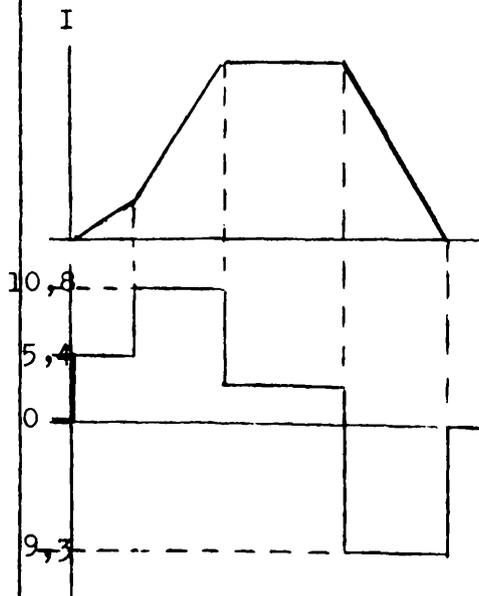
Le cycle définitif réalisable après la modification de la radio-fréquence (vers 1970) s'obtient en appliquant la pleine tension de 10,8 kV aussi bien à la montée qu'à la descente. La montée est alors deux fois plus rapide qu'actuellement, et s'effectue en régime plein redresseur. L'injection à 5400 V, 80 ms est obligatoirement en service.
