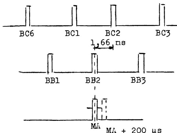
Il s'en suit une instabilité dans l'établissement du palier, et dans la durée de la montée de 1,66 ms. On s'aperçoit de cette instabilité par l'apparition de fréquents défauts de commutation sur les châssis "surveillance des commutations" des armoires 25 et 26 apparaissant toujours sur un mutateur déterminé (dans notre exemple BB2).
