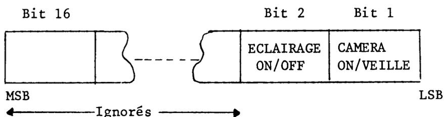
Ces deux bits sont transmis par le même type de "Dual output register" que précédemment. La commande peut être considérée comme similaire à la commande des écrans, avec les bits écran 1 et écran 2 inutilisés.
