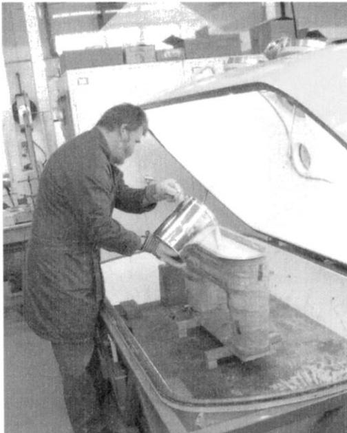
Figure 2: le remplissage du moule avec l'araldite
