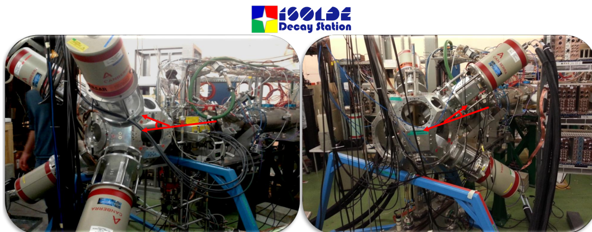
Figura 2.5 – Cambio de configuración de los clovers en la IDS. A la izquierda, su posición en IS577, uno de los primeros experimentos, a ángulos hacia delante con respecto al haz y a la derecha su posición definitiva, a ángulos hacia atrás.
