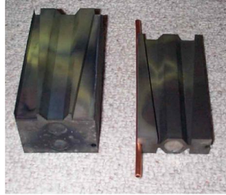
TRIUMF ISOL target Diffusion bonded Mo foils
