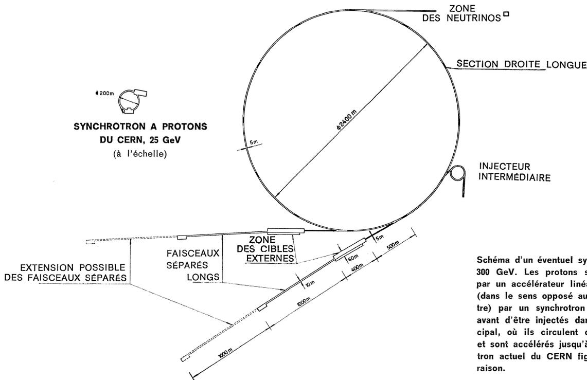
Schéma d'un éventuel synchrotron à protons de 300 GeV. Les protons sont d'abord accélérés par un accélérateur linéaire de 200 GeV, puis (dans le sens opposé aux aiguilles d'une montre) par un synchrotron à protons de 6 GeV avant d'être injectés dans le synchrotron principal, où ils circulent dans le sens contraire et sont accélérés jusqu'à 300 GeV. Le synchrotron actuel du CERN figure à titre de comparaison.
