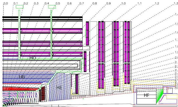
FIG. 1.7 – Schéma [15] d'une coupe transverse du calorimètre hadronique.
