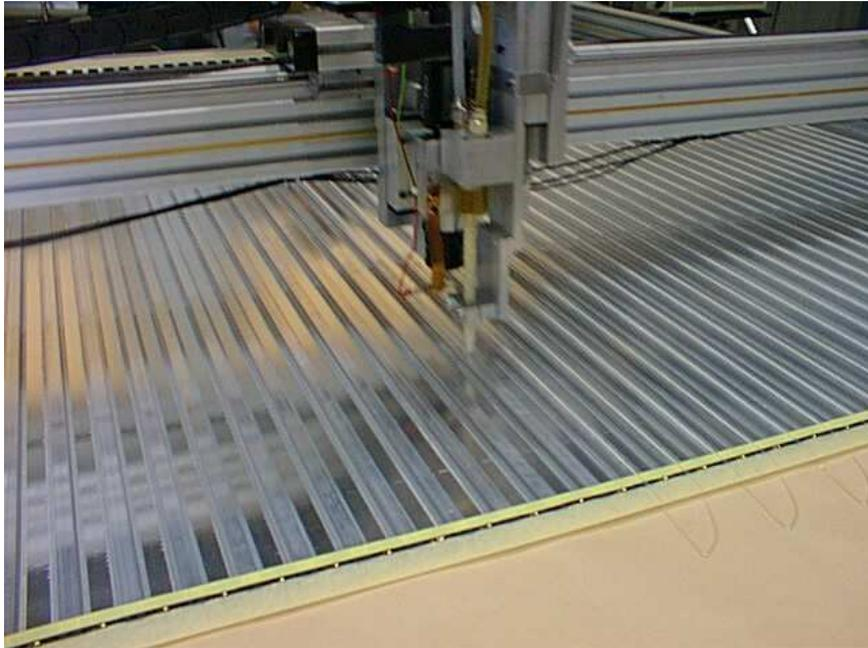
Figura 5.4: Dispensación de pegamento sobre las vigas para su posterior pegado.
