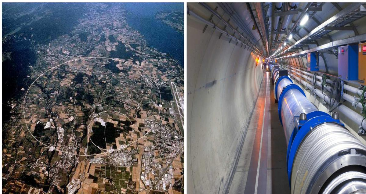
Figura 1.6: Vista aérea de la zona donde está construido el túnel que albergó LEP y que alberga el LHC. Está marcado el círculo del LHC (el de mayor radio) y el del SPS (figura izquierda). Imagen de una porción del túnel del LHC, con el tubo del haz y los imanes ya montados (figura derecha).
