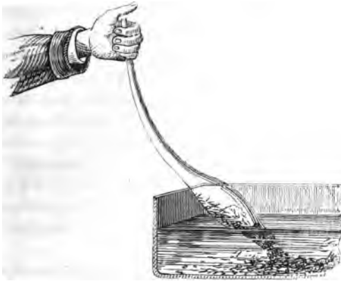
Fig. 9. Pipette courbe plongée dans l'eau, vue au moment de la levée du pouce.
