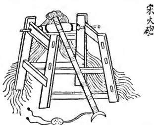
Abb. 1. Chinesische Feuer-Schleudermaschine aus der Zeit der Sung-Dynastie (960—1280 n. Chr.).
