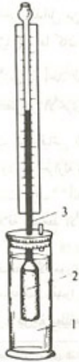
الشكل ٧٧ . جهاز لقياس الضغط الأزموزي : ١ - وعاء يحوي الماء ، ٢ - وعاء ذو جدران نصف نفوذية ، ٣ - أنبوبة .
