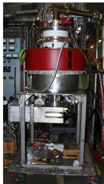
CPI MB-IOT prototype, 1MW, 700MHz
